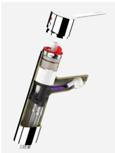
Corte 2921TEP: baixo volume de água, tecnologia EP, função choque térmico Ref. DELABIE: Corte3D_2921TEP
