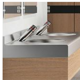
Misturadora temporizada de lavatório TEMPOMIX 3 Até 85 % de economia de água graças ao fecho automático após 7 segundos de fluxo e um débito de 3 l/min Ref. DELABIE : 794000
